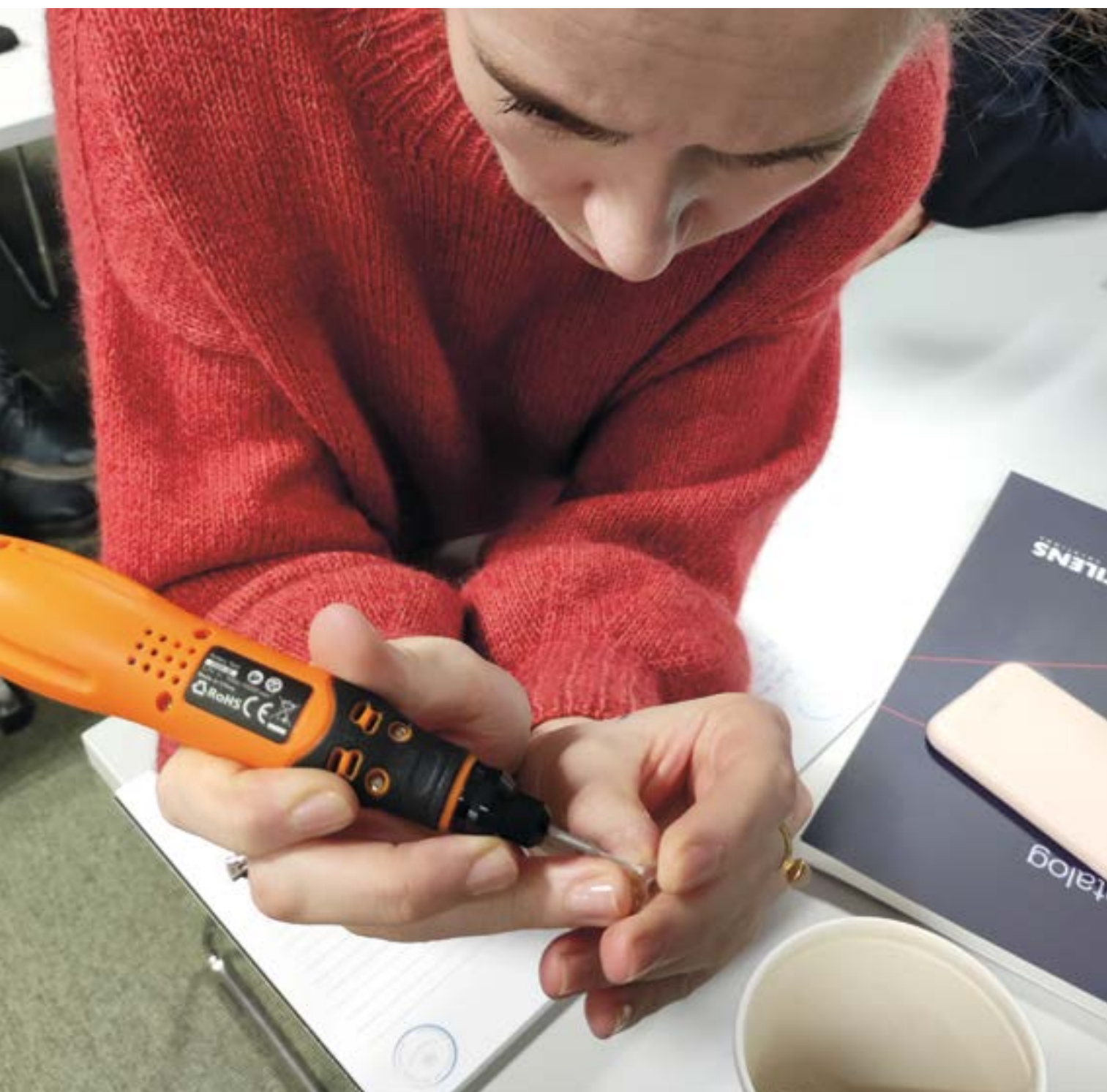
Benedicte Parelius prøver seg på å borre en fenestrering i en sklerallinse
